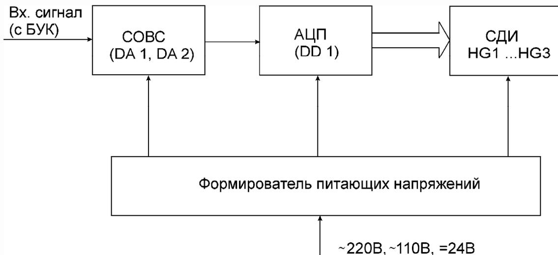
Рис. 4.1. Функциональная схема блока индикации
