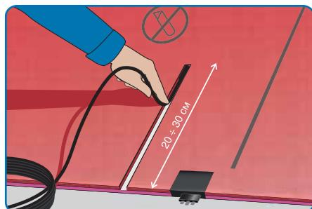
Датчик не повинен торкатись нагрівальних кабелів, а повинен розташовуватись між ними. Виріз зверху проклеюється скотчем.
