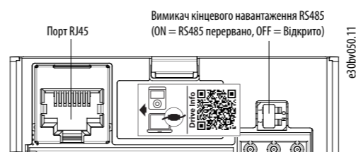
Ілюстрація 4: Порт RJ45 і вимикач кінцевого навантаження RS485
