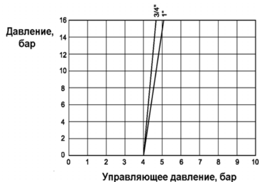
Диаметр управляющей головки \varnothing 110
