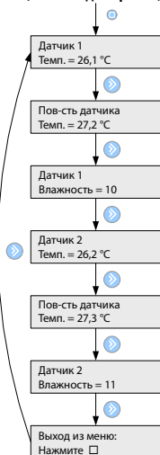
Просмотр показаний датчиков (Система для крыши)
