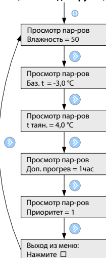
Просмотр параметров системы (Система для грунта)
