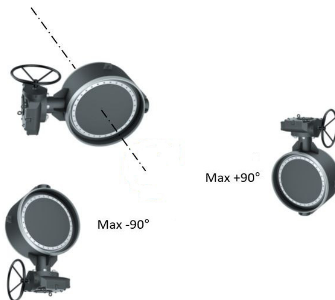
Зображення 4: Монтаж на горизонтальний трубопровід у допустиме, відмінне від рекомендованого положення
