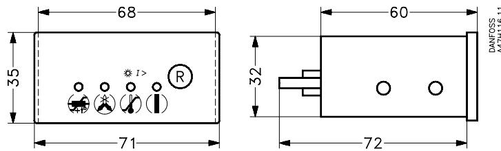
Электронное реле защиты двигателя TI 630 E
