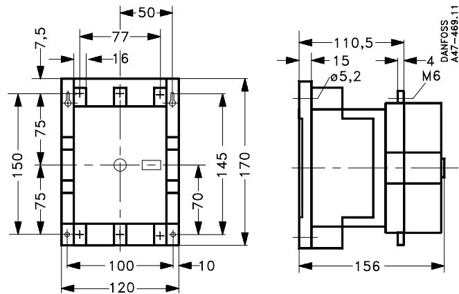
Установка механического блокиратора не требует дополнительного пространства
