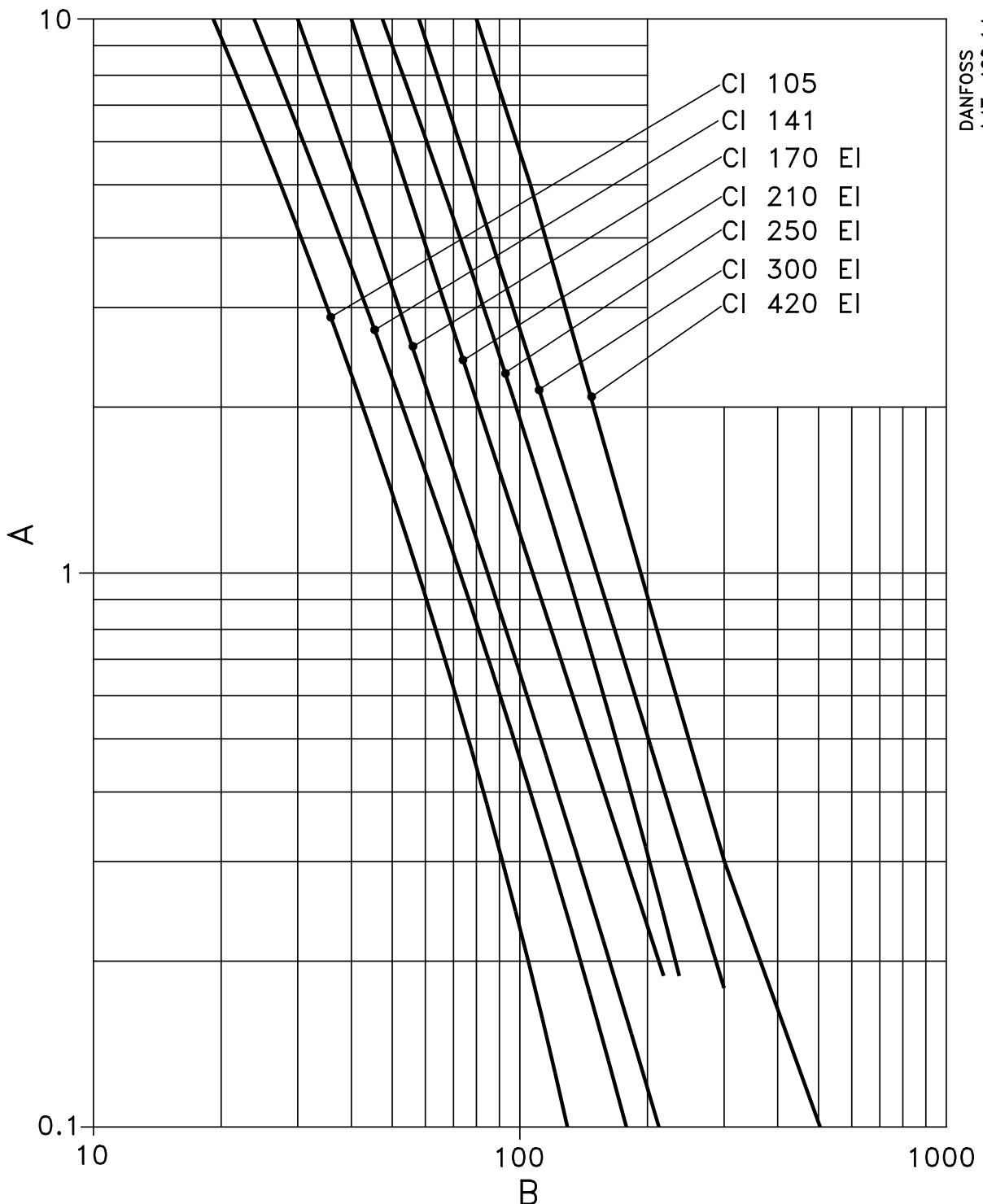
**A:** Долговечность при электрической нагрузке в миллионах срабатываний
