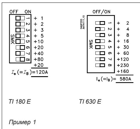
Рабочий ток реле устанавливается с помощью 8 ползунковых переключателей.
